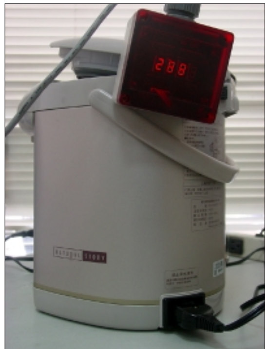
[圖一]圖中顯示量測用的熱水瓶，而右上角倒掛的是溫度計，目前顯示熱水瓶的溫度值爲88.2度
