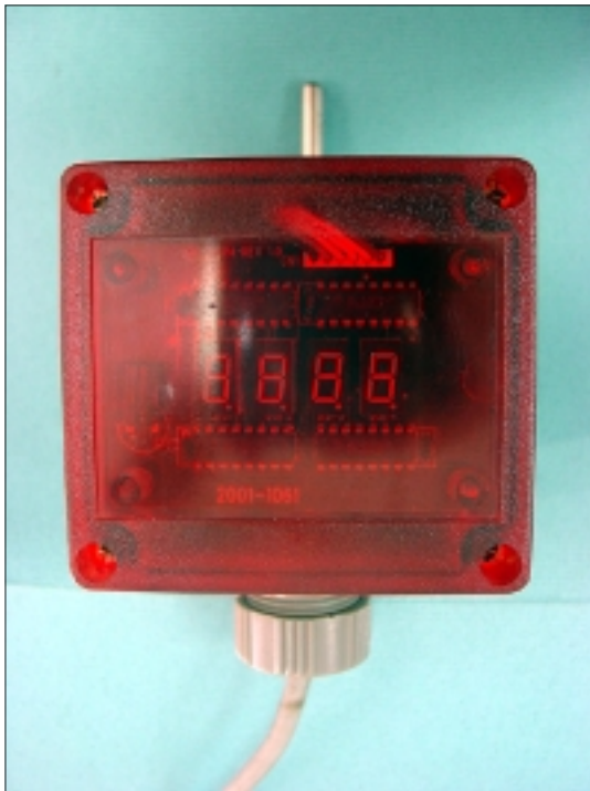
[圖二]此為量測用的溫度計，上方是不鏽鋼的感測棒，通電後中間螢幕將會顯示感測棒所感應到的溫度值
