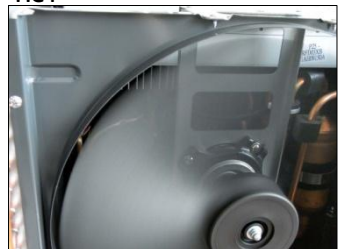
AIR CONDITIONER FAN
