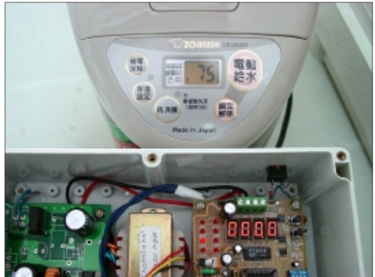
(圖三) 保溫狀態下電熱水瓶的耗電情況 熱水瓶設定保溫的溫度在60度，因此當瓶內的水溫高於60度時，熱水瓶的供電狀態相當於省電模式的耗電狀況，是幾乎不耗電的。如果低於60度，則會啓動加熱的動作，耗電量會爬升到90W左右。
