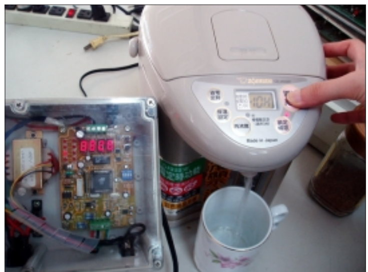
(圖四) 測量電動給水時電熱水瓶的耗電狀況 圖中量測所顯示的值爲2.6W，最高可達3.9W。
