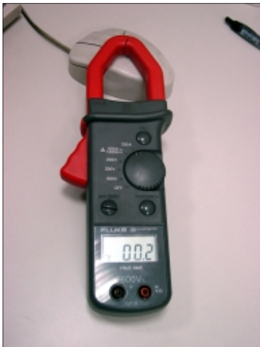
[圖 4] 我們用 Fluke 勾表來比對 URD 的交流電流，它也是以真均方根的方式顯示所測得的電流值
