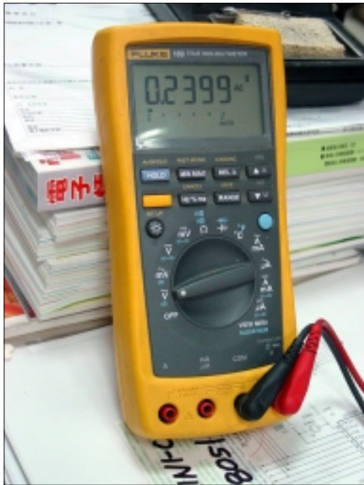
[圖 3] Fluke 數位電表的量測值絕對有公信力，我們用它來檢查交流電壓值，其顯示值為真均方根值，即所謂的 True RMS
