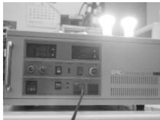
▲圖3 右上方的燈泡內部是鎢絲線，完全沒有電感抗的成份，所以電力公司送來的電力，100%變成光與熱量，由儀器上也可以換算出其PF值幾乎是1
