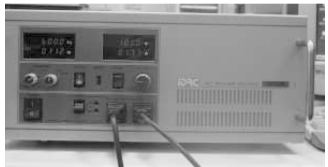
▲圖2 測試時的連接方式，從CF-500E的輸出插座分別接到PC與螢幕（各位可注意在畫面中的電源線插孔，與圖一做比較，這裡已經插上顯示器與主機的電源線）
