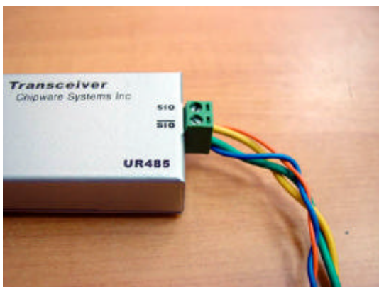
〔圖 7〕UR485 的配線圖，線材一定要對絞唷！
