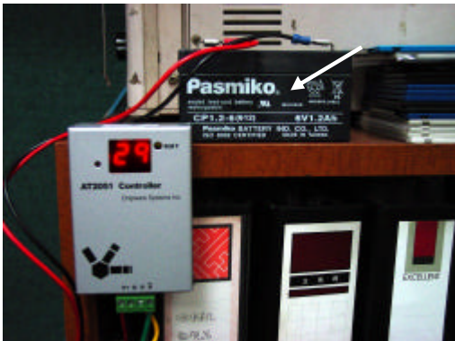
〔圖 2〕我們把 AT2051 控制板掛在書架上，單獨用一個 6V 蓄電池供電
