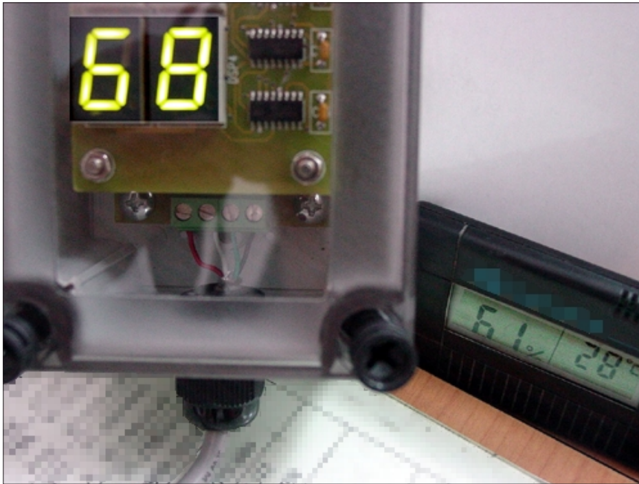
[圖 5]從冷氣房移到一般常溫的地方 強制改變環境中的濕度值，TH2040 很快地上升到環境的濕度值(約一兩秒鐘的時間)，可是一般市售的簡易濕度計還沒來得及升上來
