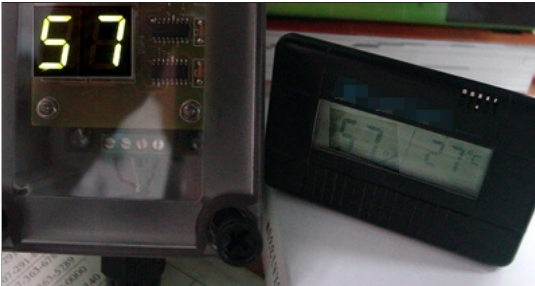
[圖 4]在冷氣房中一段時間後的濕度狀態 一般市售的簡易濕度計與 TH2040 在穩定狀態下的濕度值是接近的
