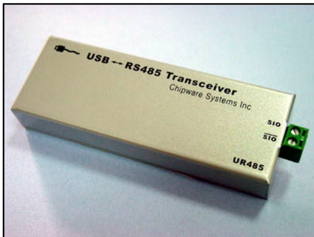
[圖 2] 如果 PC 端要透過 RS485 與 DIO-I 控制板通訊，那麼 UR485 轉接盒是最佳的選擇。
