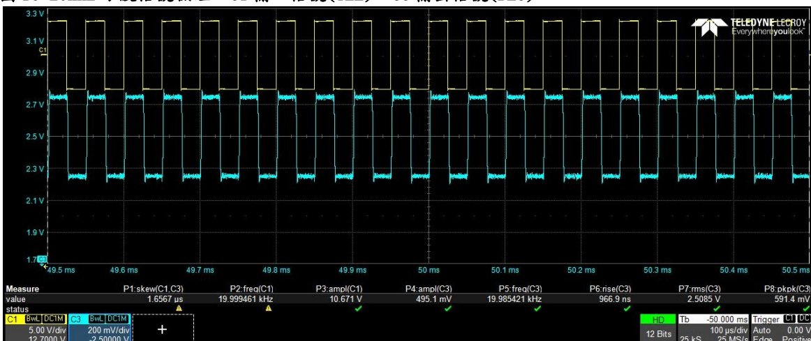
圖 16 20KHz 方波信號驗證。C1 輸入信號(YEL)，C3 輸出信號(BLU)
