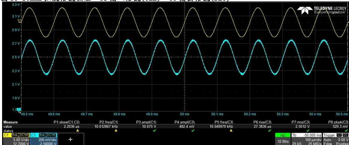
圖 13 10KHz 弦波信號驗證。C1 輸入信號(YEL)，C3 輸出信號(BLU)
