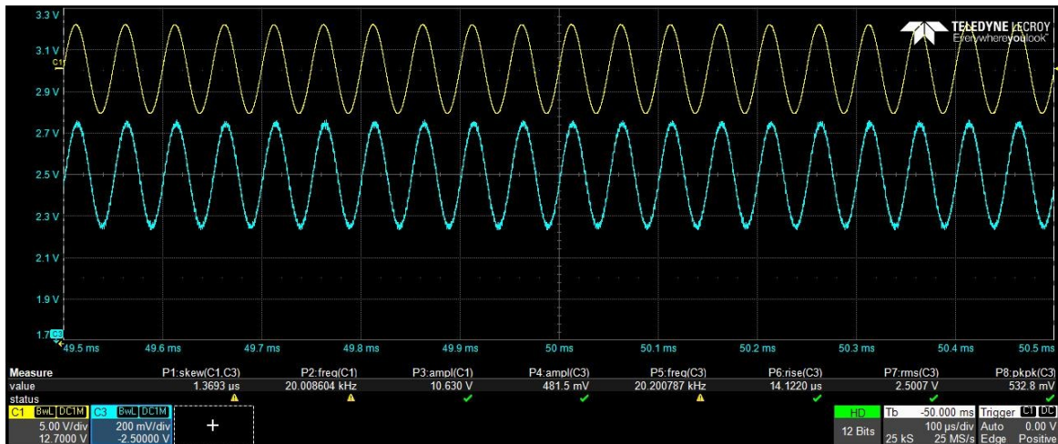
圖 14 20KHz 弦波信號驗證。C1 輸入信號(YEL)，C3 輸出信號(BLU)
