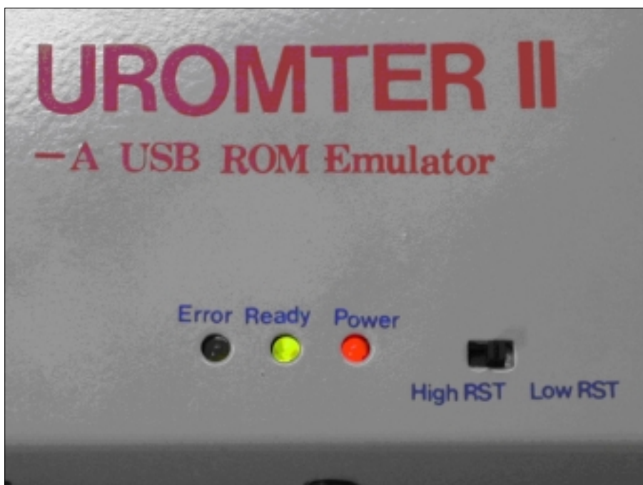
〔圖 9〕 依據目標板得重置信號要求，來設定 “重置” 的模式
