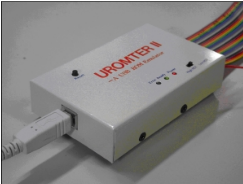
〔圖 10〕 將USB線插入 UROMTER II 以連接PC電腦
