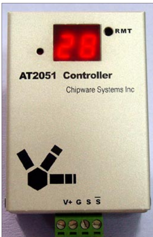
(圖7) AT2051 控制板也有 RS485 的界面
