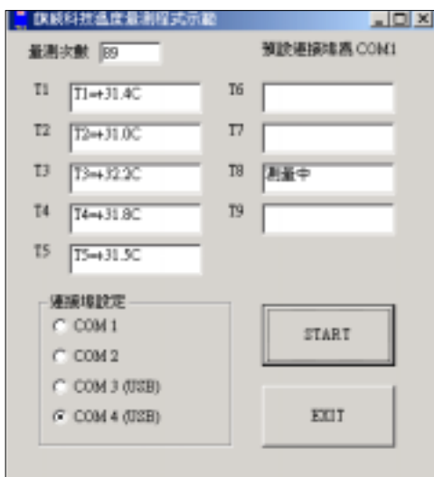
〔圖 10〕 Windows 的畫面比較精緻，但是送出的程序也是相同的，每次送出一個 ID 值到 RS485 線上，對應的 AT2051 控制板就回送一個溫度值來，若沒有回應時，也不再等待而改送下一個 ID 值。
