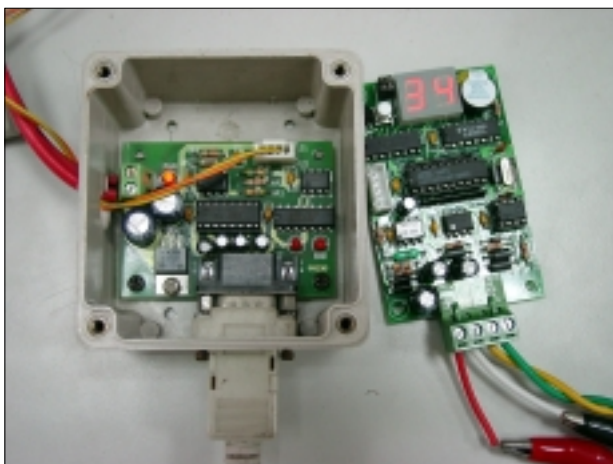
〔圖 7〕 USB 對 RS485 轉換板 (下方為 AT2051 控制板)
