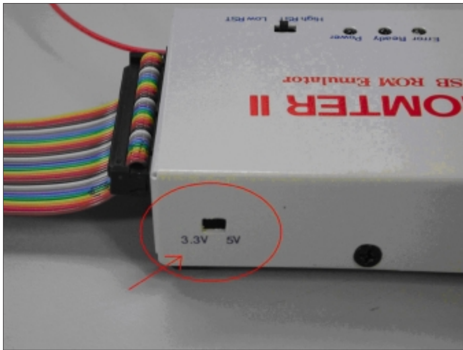
〔圖 8〕 依照您的目標板來選擇電壓
